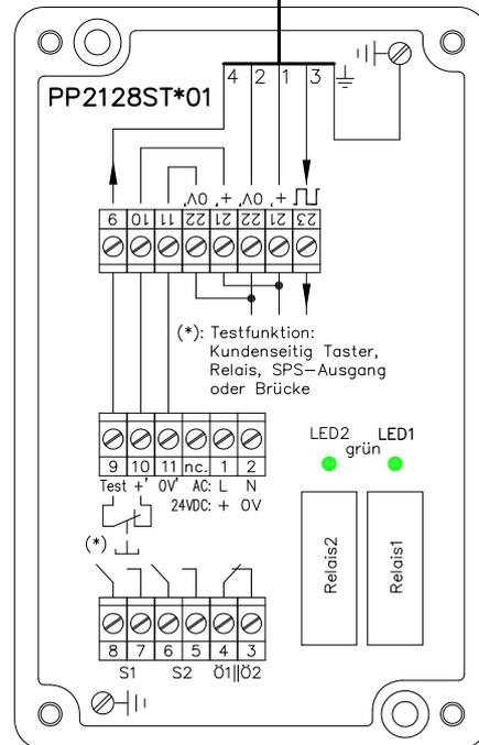
Die Relaiskontakte 3/4, 5/6 und 7/8 sind extern mit maximal 6A abzusichern! Das parallele Öffnerpaar auf 3/4 darf nur für Meldezwecke verwendet werden!
