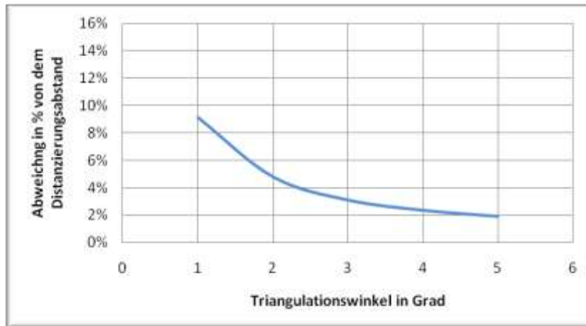
Abb.: 4.5.3: Toleranz in Abhängigkeit des Triangulationswinkels
