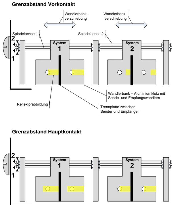
**Beispiel:** Reflektorabbildungen auf der Wandlerbank bei Grenzabstand, für nach links aufgespannte horizontale Triangulationsdreiecke.
